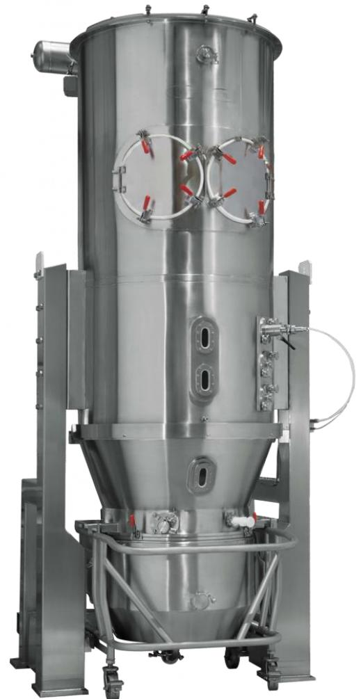
VFC-120 FLO-COATER® с конструкцией из 2-х частей и вентиляцией
