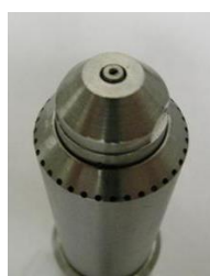
Пистолет-распылитель ускорителя Wurster имеет большое сопловое отверстие и ряд отверстий, отводящих продукт под углом 45°
