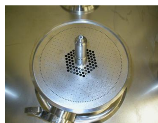
Распределительная пластина Wurster разработана для точного перемещения продукта через зону распыления.
