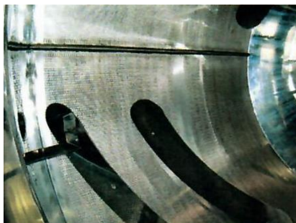
VHC-66L HI-COATER. Интерьер барабана на 1000 Л, со смесительными и противоскользкими перегородками и шлицевой перфорацией
