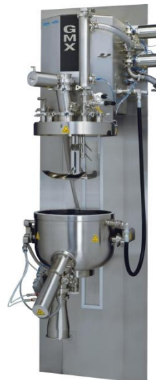
Настенная модель в конфигурации чаша с рубашкой и вакуумная сушка
